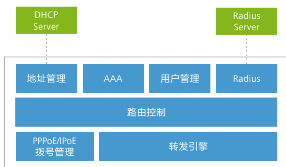
图2 传统BRAS设备系统架构
